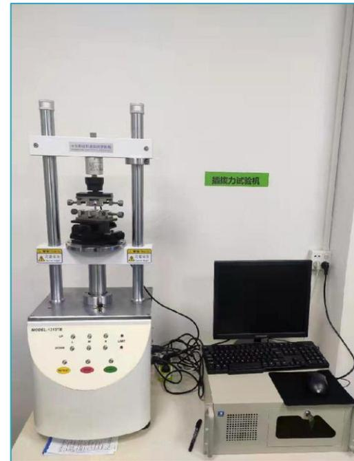
插、拔力測試儀
